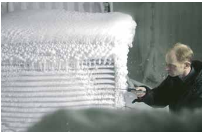
I kylrummet testas värmepumparna vid extrema temperaturer.
